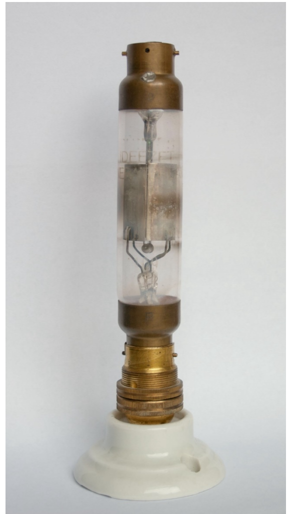
■ Philips-Ideezet-Generatorlamp 10W zendlamp voor een gloeidraadvoeding van 6V / 2.25A, opvolger van de versie voor 6V / 1.6A. (Collectie: Maarten Gudde)
